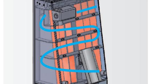
**06. COLLEGAMENTI IDRAULICI:** termostufa completa di tutti gli elementi idraulici per riscaldare l'acqua e facilmente ispezionabile per manutenzioni o pulizie.
